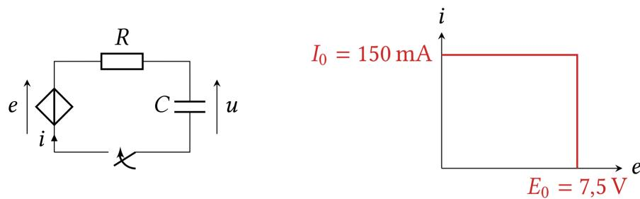
La résistance vaut  $R = 20 \Omega$  et la capacité du condensateur  $C = 50 \mu\text{F}$ . Au contraire d'un générateur de tension, la caractéristique d'une alimentation stabilisée est non-linéaire, rectiligne par morceaux, ce qui change évidemment le comportement du circuit.
